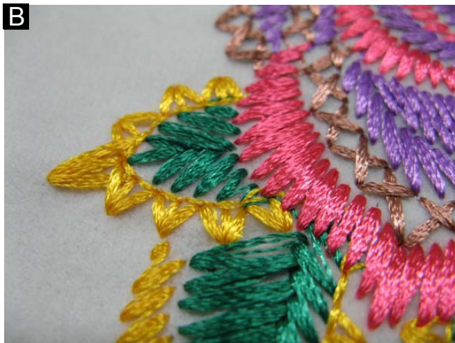
Linha com torção fraca (Nível intermediário entre A e C) (Polyester 120d/2)
